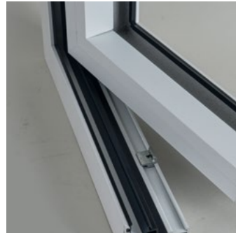
단열 P.F.폼 삽입으로 열관류율 향상 열관류율 1.131 (42T 유리적용) 열관류율 1.393 (24T 유리적용)
