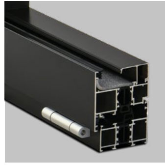
단열 P.F.폼 삽입으로 열관류율 향상 열관류율 1.131 (42T 유리적용) 열관류율 1.393 (24T 유리적용)
