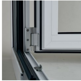
격벽구조의 폴리아미드, 3중 가스켓 구조, 미들 가스켓 적용으로 단열, 기밀, 방음 성능 향상
