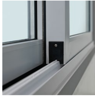
중공부 P.F.품 적용으로 열대류 차단, 단열성능 개선 열관류율 1.166 (43T 유리적용) 열관류율 1.572 (24T 유리적용)
