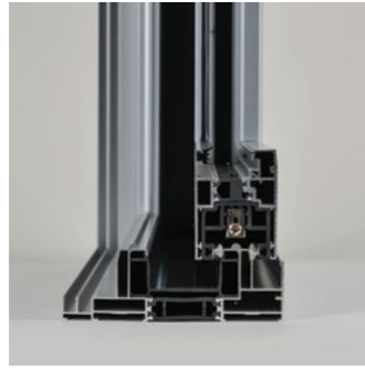
중공부 P.F.품 적용으로 열대류 차단, 단열성능 개선 열관류율 1.166 (43T 유리적용) 열관류율 1.572 (24T 유리적용)
