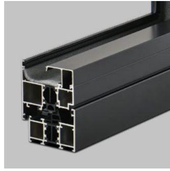
격벽구조의 폴리아미드, 3중 가스켓 구조, 미들 가스켓 적용으로 단열, 기밀, 방음 성능 향상
